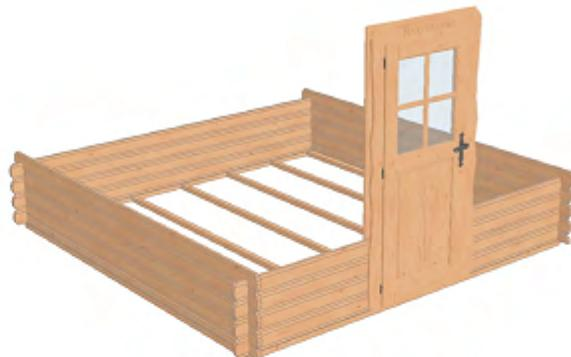
Proseguire incastrando le tavole delle pareti seguendo lo schema di montaggio. Dopo i primi quattro giri di tavole inserire il monoblocco della porta. Proseguire poi con le pareti.
